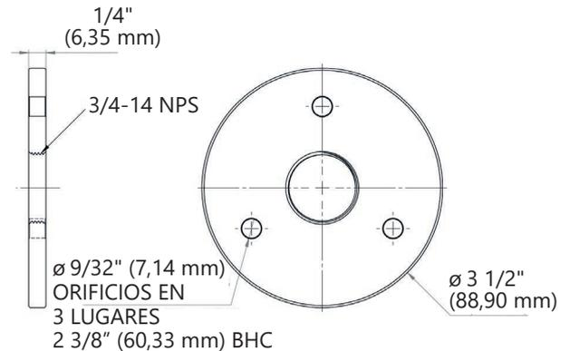
**Acoplamiento de montaje (soldadura a recipiente).**
