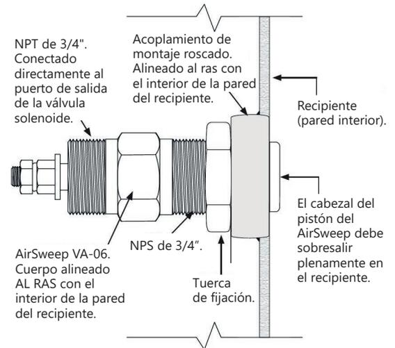
*En las paredes del contenedor pronunciadamente curvas, el AirSweep se instalará en la parte superior e inferior (posiciones 12:00 y 6:00), y debe estar al ras con los lados (posiciones 3:00 y 9:00). Para lograr la máxima eficacia, la distancia de conexión entre el AirSweep y la válvula solenoide debe ser la más corta posible. Si es posible, utiliza únicamente la boquilla de conexión suministrada sin codos ni tuberías adicionales.*
